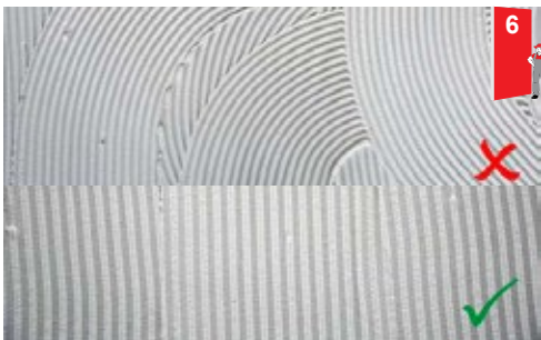
۶ • اعمال چسب در یک جهت و موازی با بعد کوتاه تر اسلب
